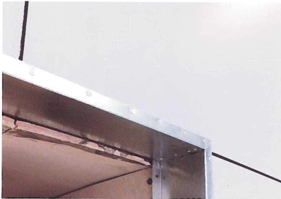
Bild 4 Detailaufnahme vor Versuchsbeginn – Stahlblech im Sturz
