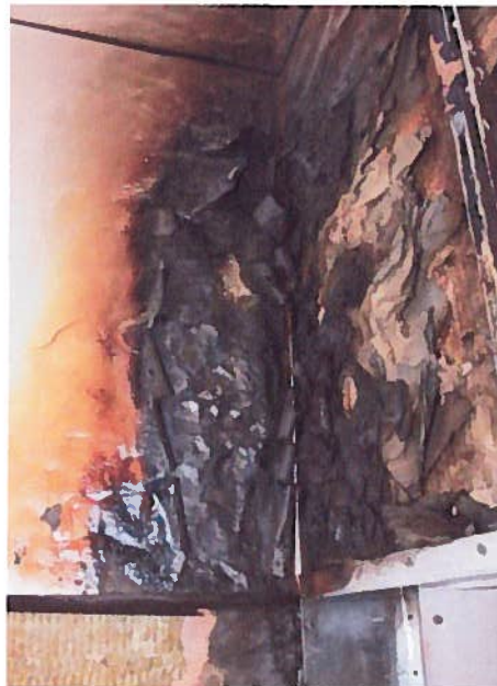
Bild 14 Detailaufnahme nach Versuchsende – thermische Beschädigung der beflamten Platten
