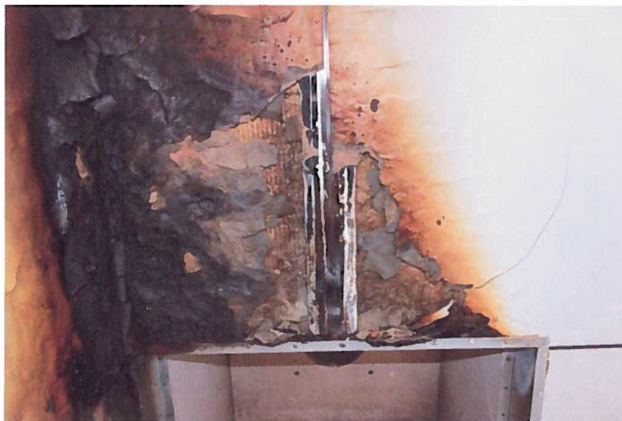
Bild 12 Übersichtsaufnahme nach Versuchsende - geöffnete Außenschicht
